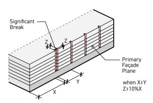
Figure 4.7b: SIGNIFICANT BREAKS B
