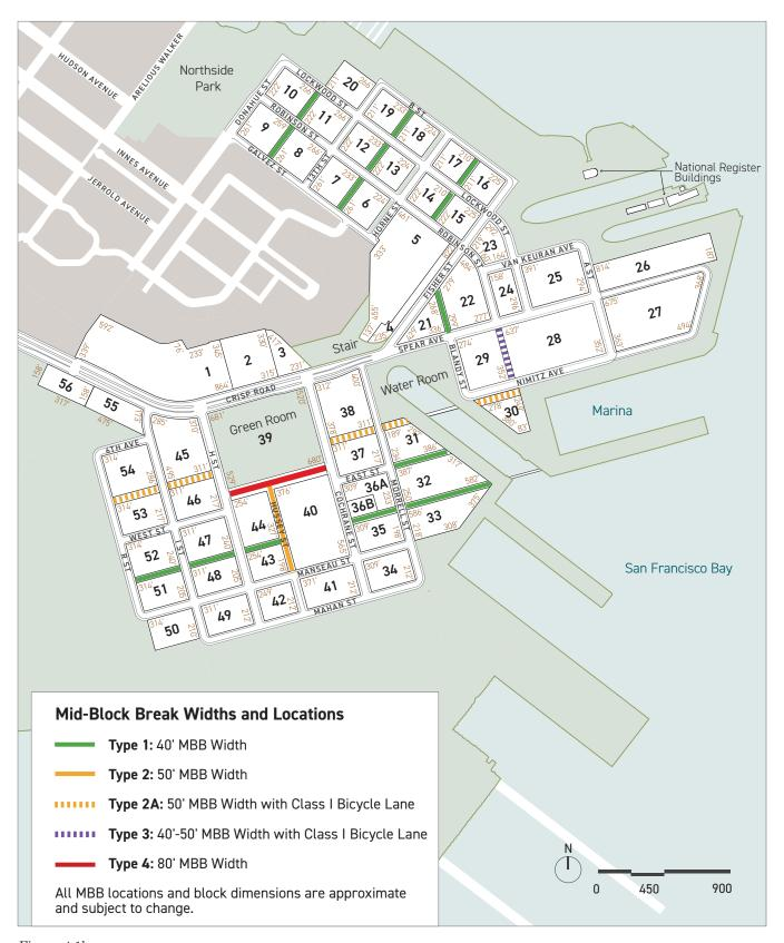
$Figure \ 4.1b$ : MID-BLOCK BREAK WIDTHS AND LOCATIONS
